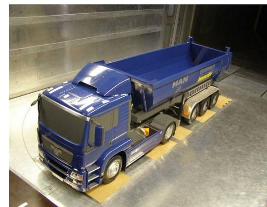
Le differenze nei consumi si basano esclusivamente sulle differenze di resistenza aerodinamica ( $c_w \cdot A$ ), contenitore ribaltabile vuoto
