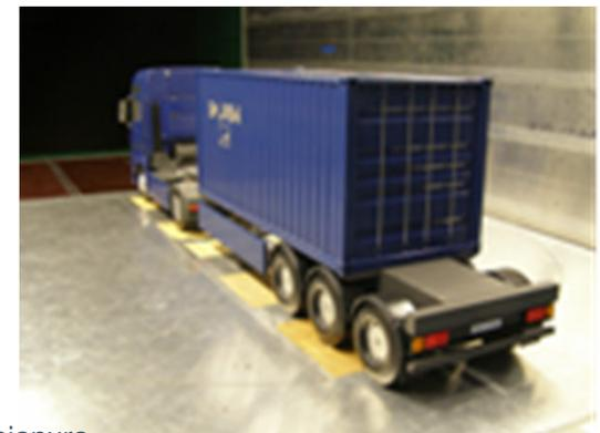
Le differenze nei consumi si basano esclusivamente sulle differenze di resistenza aerodinamica ( $c_w * A$ )
