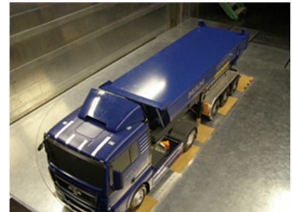
Le differenze nei consumi si basano esclusivamente sulle differenze di resistenza aerodinamica ( $c_w \cdot A$ ), contenitore ribaltabile coperto
