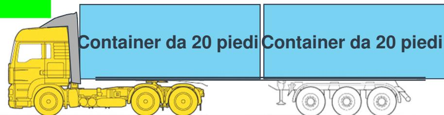
Le differenze nei consumi si basano esclusivamente sulle differenze di resistenza aerodinamica ( $c_w \cdot A$ )
